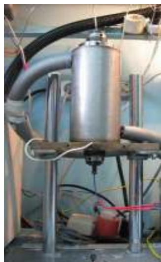
Рис. 2. Внешний вид камеры высокого давления.
