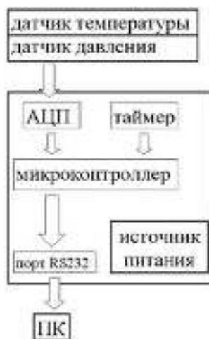
Рис. 4. Функциональная схема устройства для измерения температуры и теплопроводности.
